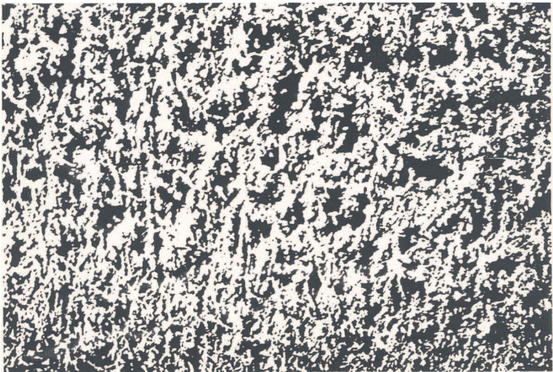
Fig. 2 - Cristalli di titanio prodotti con processo Ginatta
