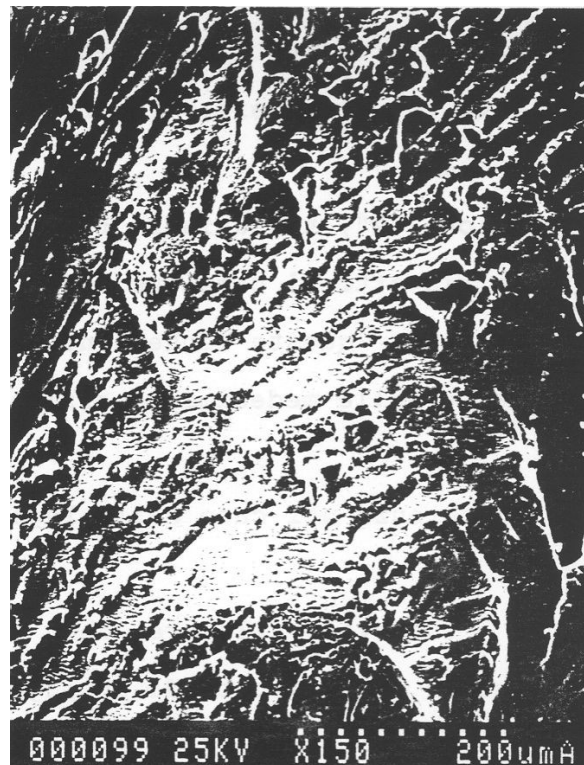
Fig. 10 - Micrografia SEM della superficie di frattura di fatica del campione solubilizzato (a circa 20 mm dall'intaglio).
