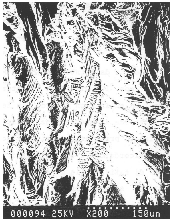
Fig. 8 - Micrografia SEM della superficie di frattura di fatica del campione solubilizzato (a circa 4 mm dall'intaglio).
