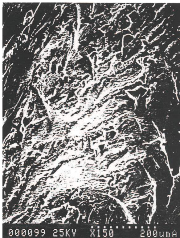
Fig. 10 - Micrografia SEM della superficie di frattura di fatica del campione solubilizzato (a circa 20 mm dall'intaglio).
