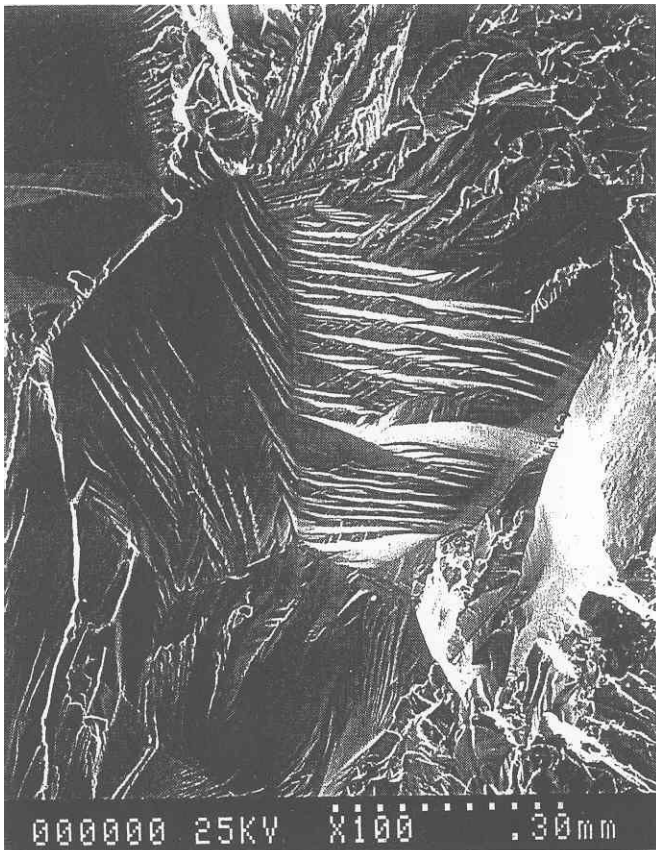
Fig.6: Micrografia SEM della superficie di frattura di fatica dei campioni:
