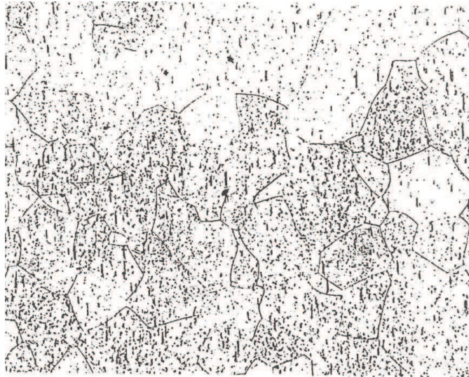
FIG.2: Micrografia ottica della lega solubilizzata (x50)
