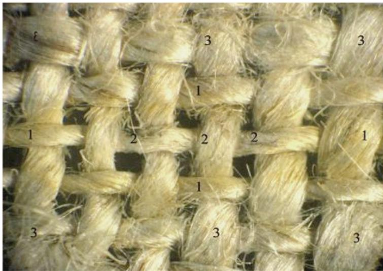
**Figura 5.** L'area del lino irraggiato dall'impulso del laser eccimero ArF mostra differenti caratteristiche che corrispondono ai valori locali della intensità  $I(x,y)$ . 1) area colorata; 2) area ablata; 3) area irraggiata al di sotto della soglia di colorazione. Foto tratta dalla referenza [32].
