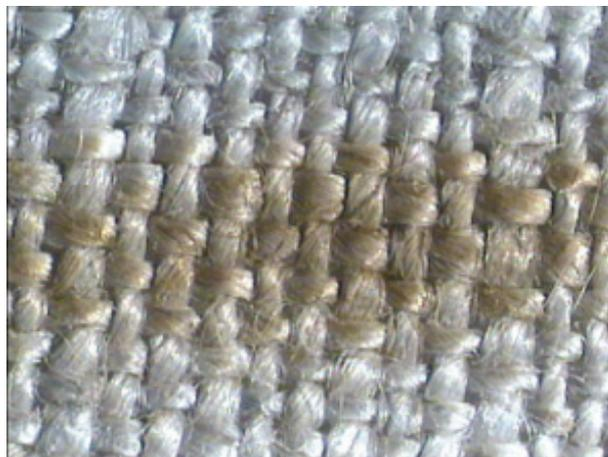
**Figura 3.** Foto al microscopio del tessuto di lino irraggiato con 100 impulsi laser XeCl ( $\lambda = 0,308 \mu\text{m}$ ) e intensità sul lino  $I = 16 \text{ MW/cm}^2/\text{impulso}$ . Ricordiamo che  $1 \text{ MW} = \text{un milione di Watt}$ .
