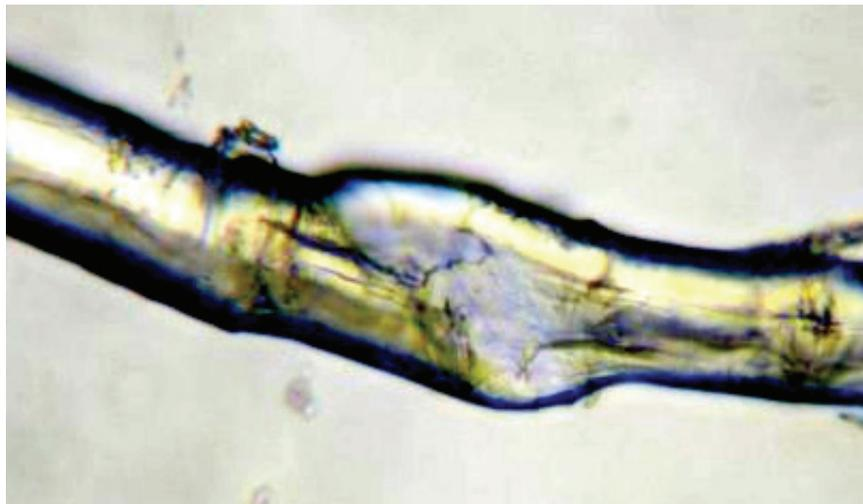
**Figura 7.** Immagine al microscopio di una singola fibrilla di lino colorata con il laser ArF. Il danneggiamento meccanico nella parte centrale mostra la parte interna della medulla incolore. Il diametro medio della fibrilla è di 20  $\mu\text{m}$ . Questa immagine è stata ottenuta aumentando il contrasto di un dettaglio della Figura 8 nella referenza [32].
